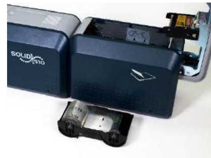
Рис. 22 Установка пленки ламинатора
