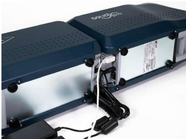
Рис. 11 SOLID-510L Коннект обоих кабелей питания и USB-провода
