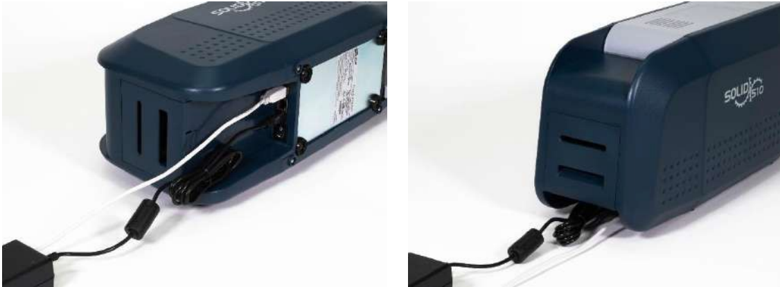
Рис. 10 SOLID-510D Коннект кабеля питания и USB кабеля
