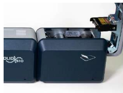
Рис. 23 Установка пленки ламинатора
