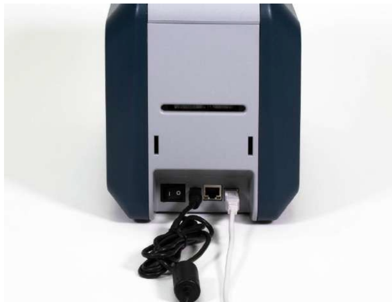
Рис. 9 SOLID-510S Коннект кабеля питания и USB кабеля
