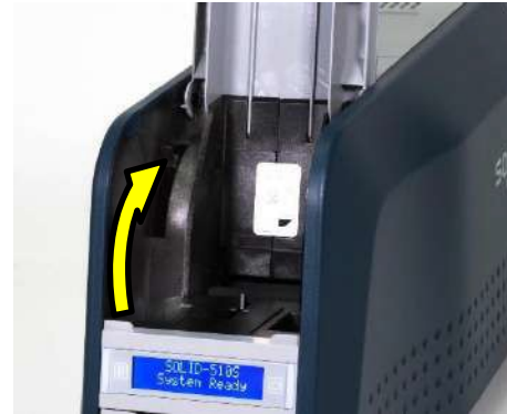
Рис. 24 Механизм настройки толщины карт
