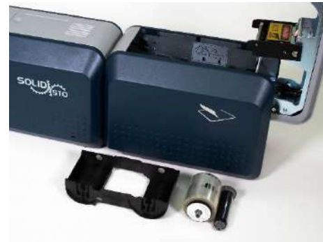
Рис. 21 Удалите картридж с ламинирующей лентой
