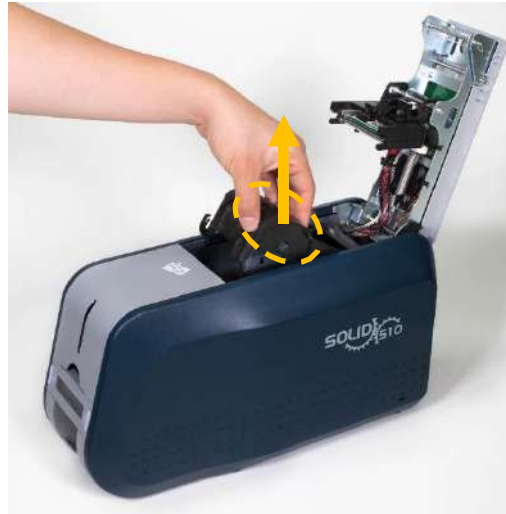
Рис. 14 Изъятие картриджа с печатной лентой
