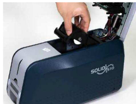
Рис. 19 Установка съемного картриджа с лентой
